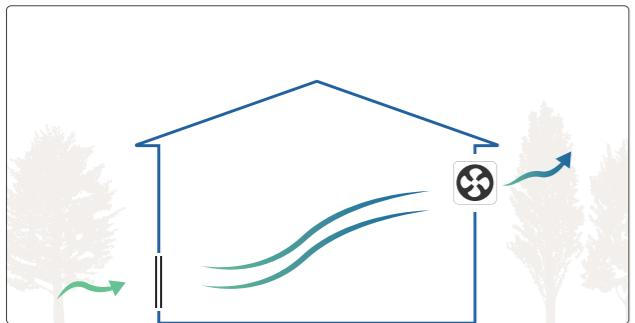
給気を自然に、排気を機械で行う換気方式です。
