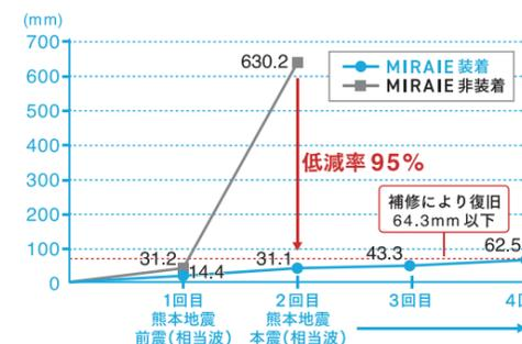
※2017年1月京大防災研究所でのMIRAIE軸組を使用した実大実験の結果であり、震度7相当の加振2回目の地震波に対する層間変形(揺れ幅)の比較による。
