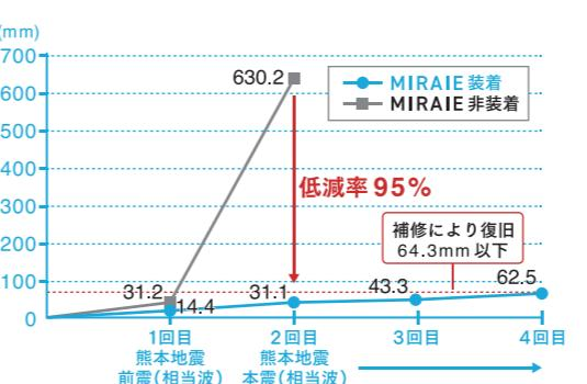
\*2017年1月京都大学防災研究所でのMIRAI<sup>E</sup>軸組を使用した実大実験の結果であり、震度7相当の加振2回目の地震波に対する層間変形(揺れ幅)の比較による。
