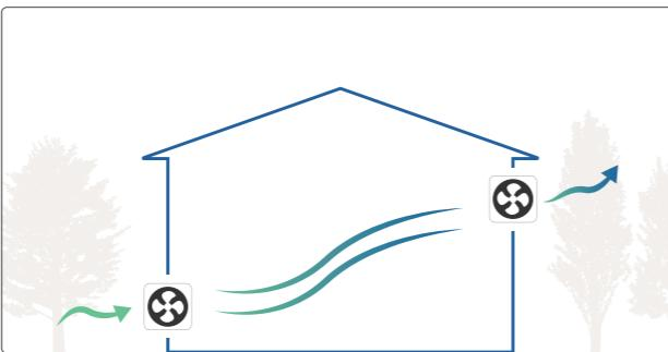
外気から取り入れた空気を熱交換器で温めて、室内に取り入れる換気方式です。給気と排気を機械で行うため、効率的な換気ができ、快適な室内環境を保つことができます。
