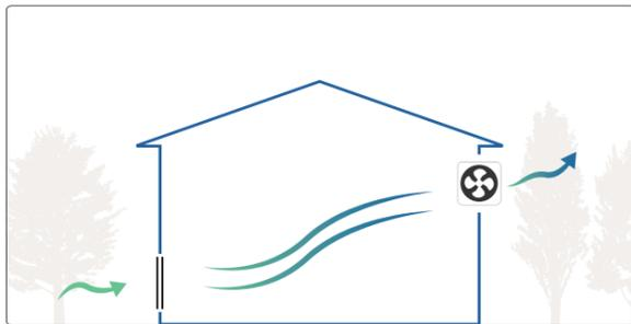
給気を自然に、排気を機械で行う換気方式です。給気口に機械を設けないのが特徴で、設置コストが比較的抑えられるため、一般住宅でよく採用されています。
